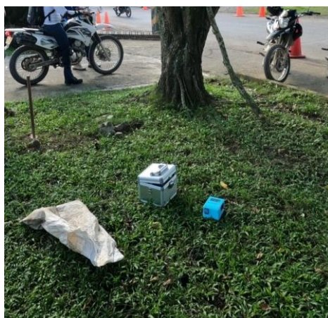
Figura 127. Emplazamiento de sensor y mazo utilizado para la generación de fuente activa.
