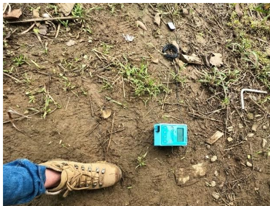
Figura 126. Emplazamiento de sensor para medición tipo H/V.
