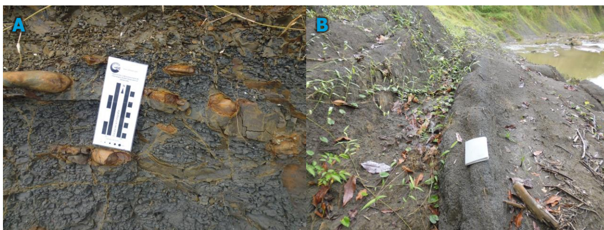
Figura 105. Afloramiento del paquete intermedio de la Formación Pavo Inferior. A. Capas de lodolitas fisiles con presencia de nódulos de siderita. B. Presencia de suelos residuales resultado de la meteorización de lodolitas. Fuente: CORPOURABA & UT POMCA Río Turbo Currulao (2018)
