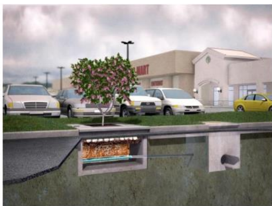
Figura 29.- Esquema común de diseño de alcorques inundables
