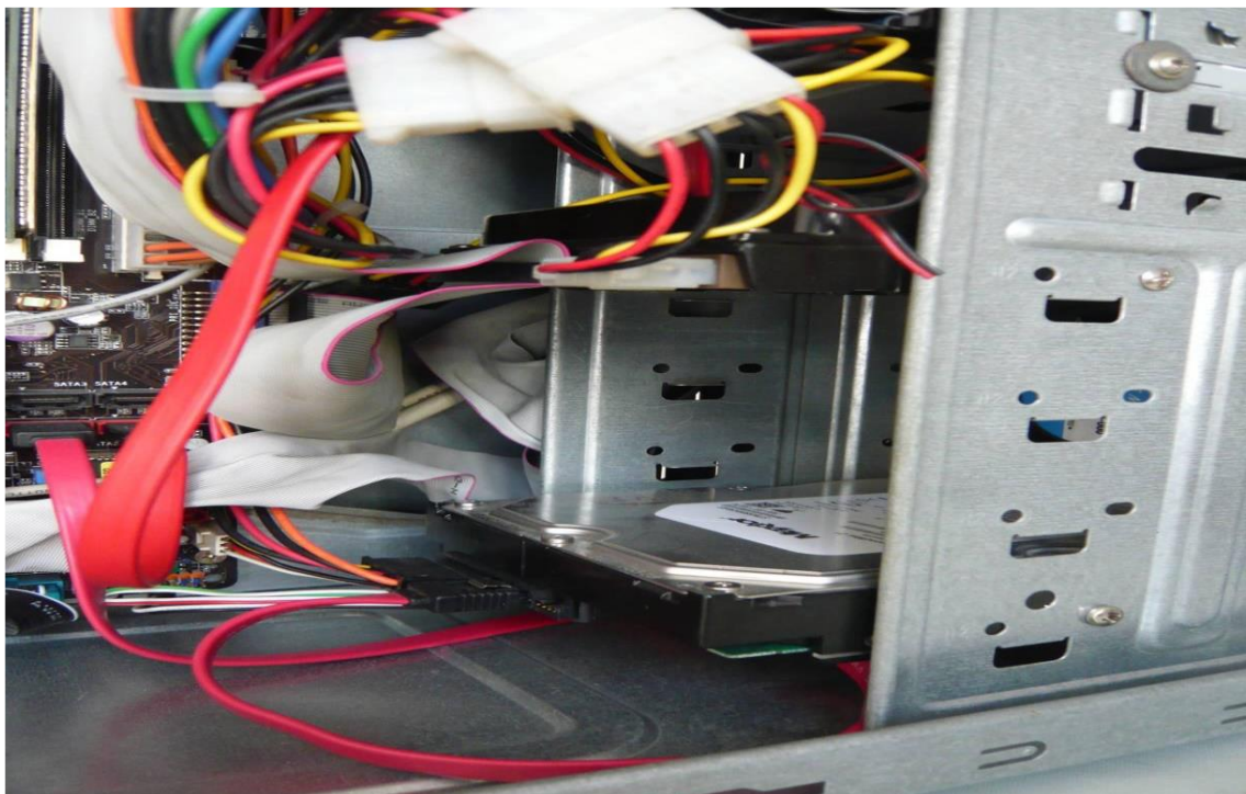
Imagen: Disco Duro dentro de una Torre de PC
