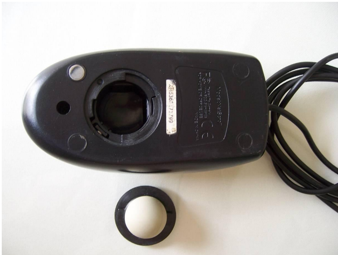
Imagen: Ratón Mecánico (Parte Inferior y rodillos)
