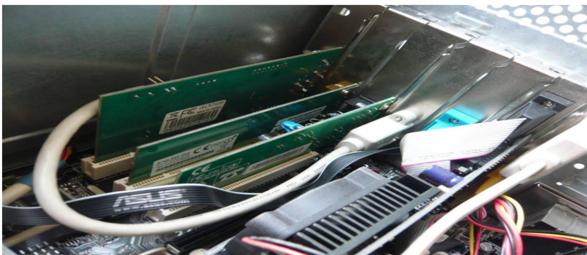
Imagen: Tarjetas de expansión Instaladas
